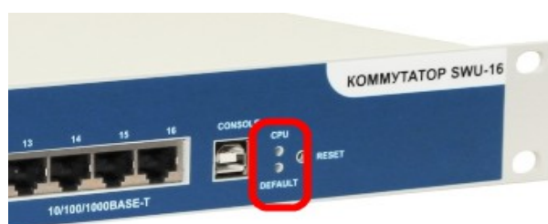
Рис.А.2. Индикаторы DEFAULT и CPU – коммутаторы SWU
