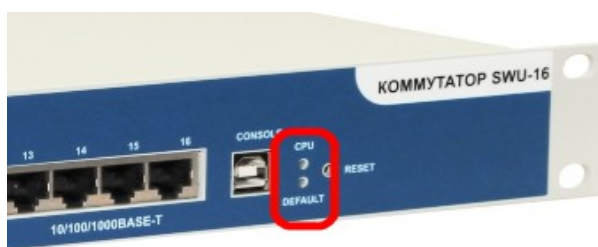
Рис.1.2. Индикаторы DEFAULT и CPU – коммутаторы SWU
